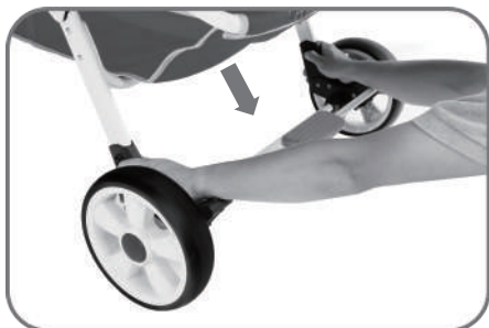
1 拆卸原有推車後車輪架。
